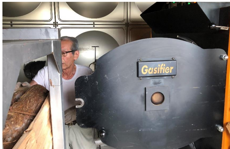
薪の投入作業 (徒歩数分の所に住んでいる方が2名シフトで行う)
