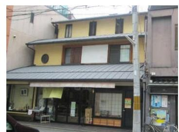
1階、2階に軒庇を設け、3階部分の壁面線を後退させている例
