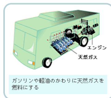
天然ガス自動車の仕組み
