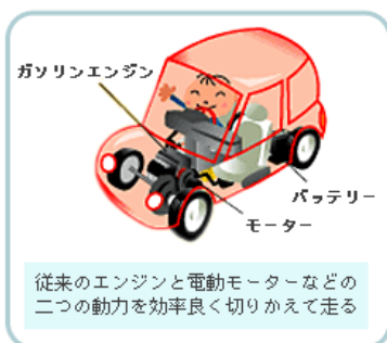
ハイブリッド自動車の仕組み
