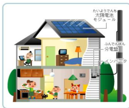
住宅用太陽光発電システム
