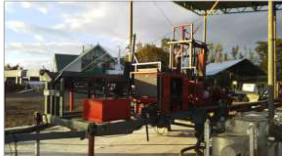
改造を重ねて使われている大型薪割り機
