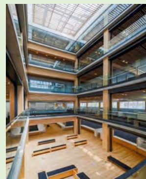
自然採光・自然換気：長門市
