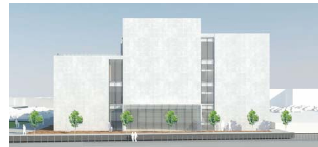
【西側立面：ガラス面を最小限に抑え熱負荷を低減】
